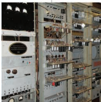
La Small-Scale Experimental Machine, progettata e costruita nel 1948 alla Victoria University di Manchester, è il primo computer a eseguire un programma contenuto in una memoria elettronica.
