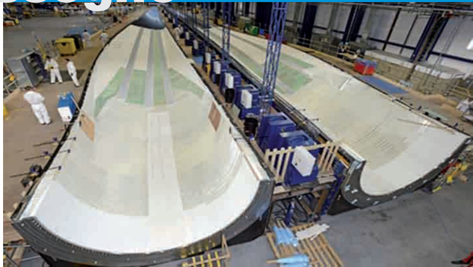
Stampi per pale da 80 metri, sviluppate da Vestas.
